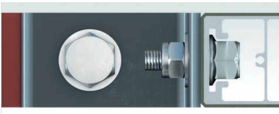
Exemple de fixation sur équerres d'assemblage (non fournies) via écrous freinés.
