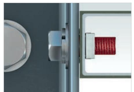
Exemple de supports d'assemblage fixés avec des boulons et de la colle anaérobie, par ex. «Filet de casier». Les trous pré-perçés sont plus larges que l'axe du boulon (2 à 4 mm) pour permettre l'expansion de la planche. Les rondelles sont requises comme indiqué.
